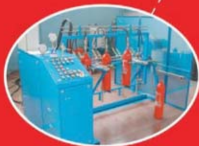
UNITA' DI MANUTENZIONE E COLLAUDO PER BOMBOLE E SERBATOI
