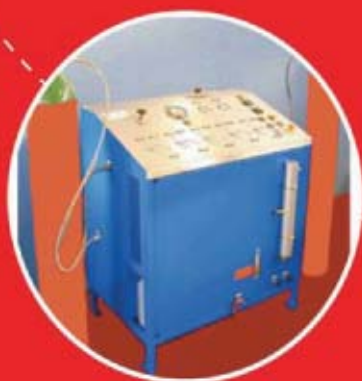
• UNITA' PER RIEMPIMENTO BOMBOLE CON GAS INERTI
